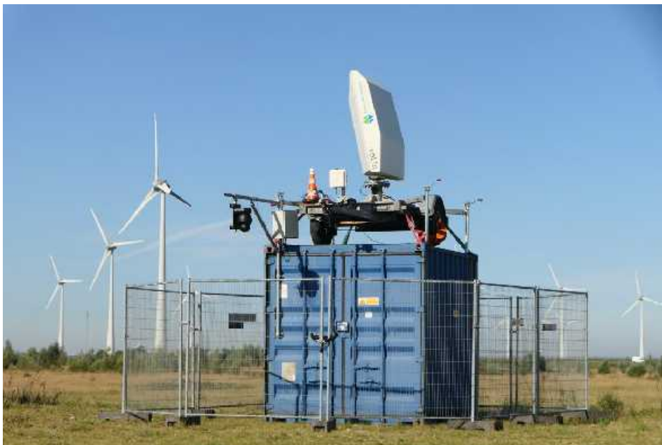
Figuur 6.1 Max® 3D vogelradar van Waardenburg Ecology in de Eemshaven. De windturbine met de zwarte wiek in de achtergrond is windturbine 20.
