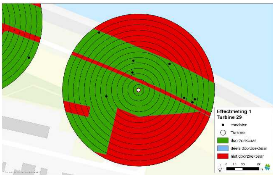
Figuur BI.12 Doorzocht oppervlak per ring in het eerste jaar effectmeting bij windturbines 28 en 29 (set 5), in de rondes waarin de slachtoffers (punten) bij deze windturbines zijn gevonden.
