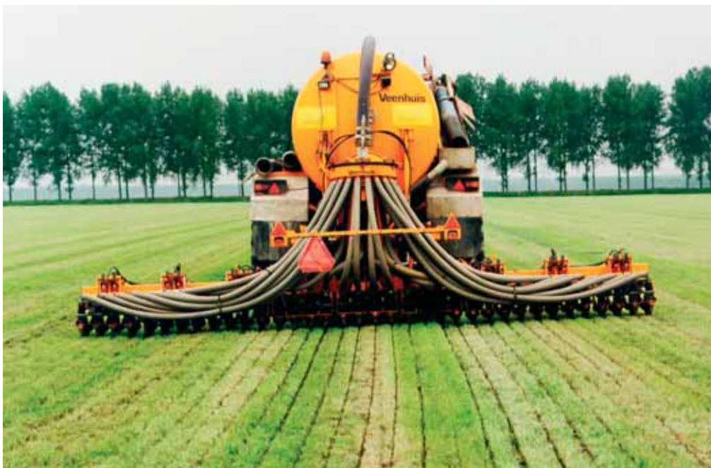
Foto 2. Een zodebemester. Deze legt de drijfmest in de bodem in sleufjes van ca 5 cm diep (foto: Animal Sciences Group).
