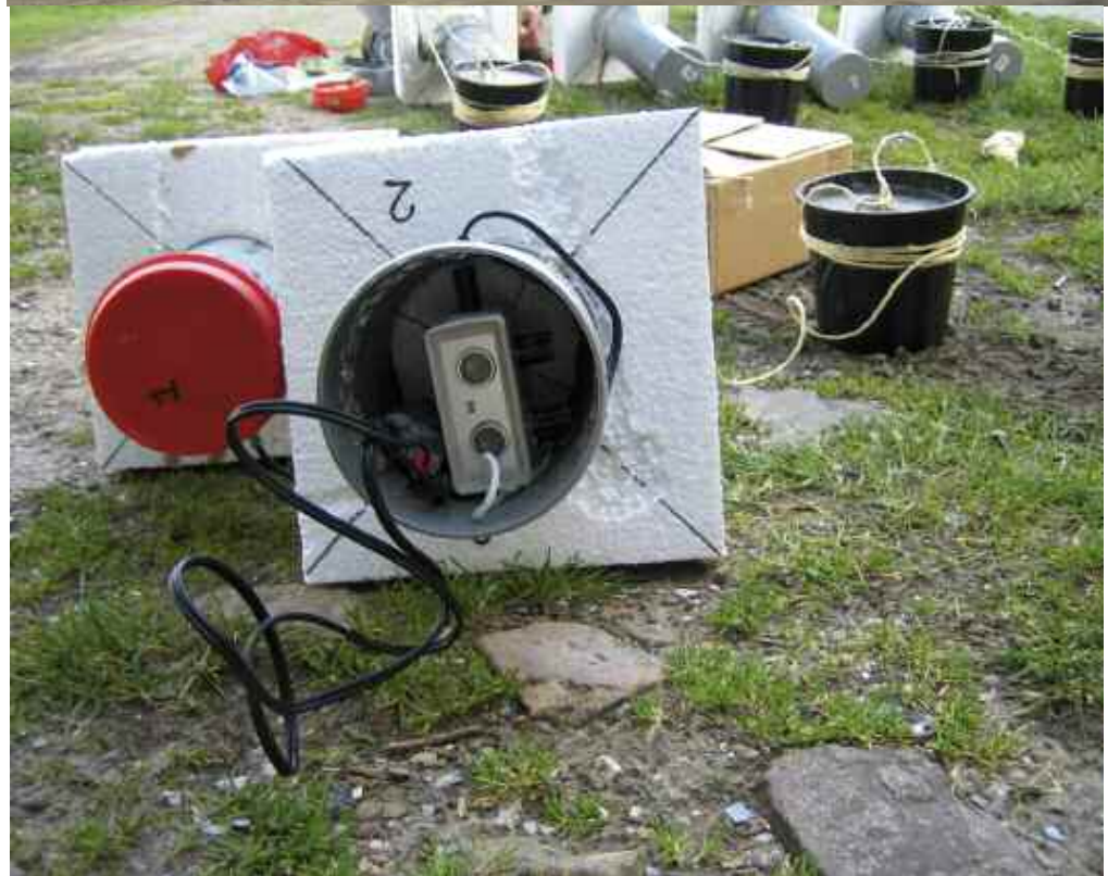
Foto 1a & 1b. Drijvende boeien met daarin de onbemande batdetectors. Passages van vleermuizen worden door de boeien geregistreerd (foto's: A&W).
