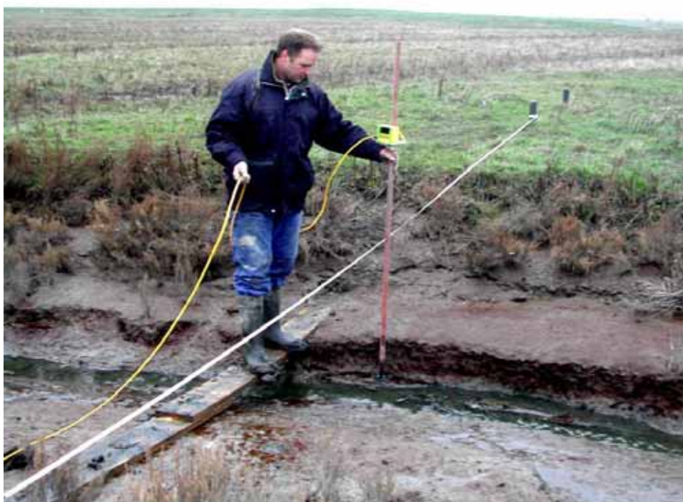
Foto 3.1 Kreekprofielmeting met behulp van de Compulevel.
