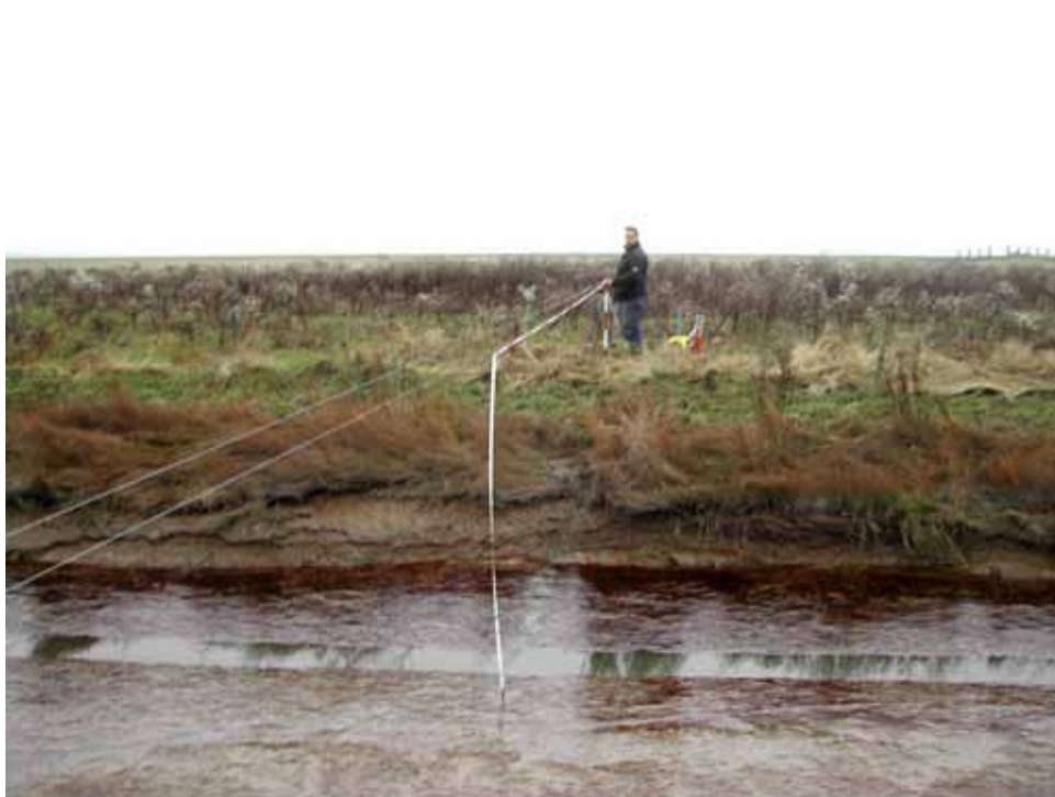
Foto 3.2 Kreekprofielmeting met behulp van de alternatieve (“waslijn”) methode.
