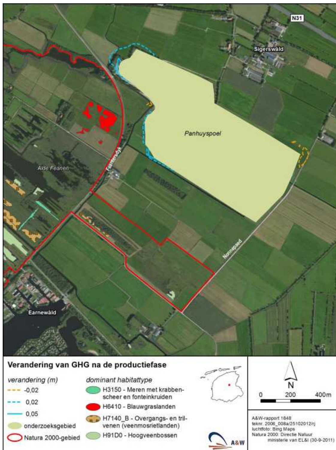
Figuur 5.5 - Verandering van de Gemiddeld Hoogste Grondwaterstand nadat zandwinning in de uitbreiding is beëindigd.
