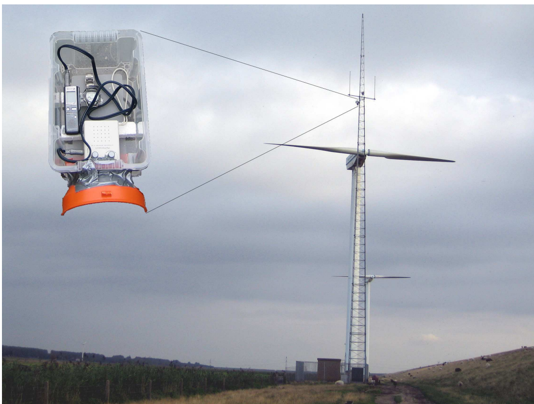
Luisterkistjes (boven) met batdetector die gekoppeld is aan een voicerecorder en een horloge die om de tien minuten een signaal geeft. Eén van deze luisterkistjes is ingezet om op hoogte vleermuizen waar te nemen (beneden, aan zendmast).
