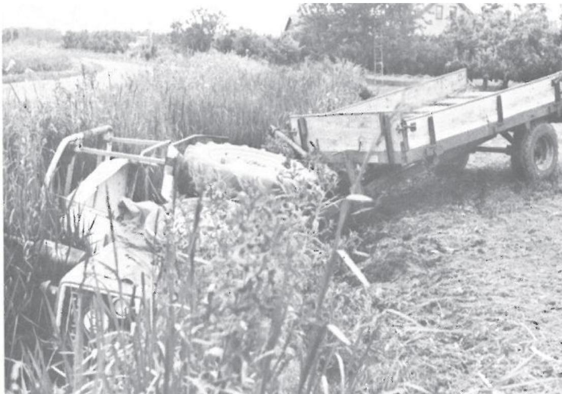
Foto: Gekantelde tractor in een door Muskusratten ondergraven oever (Zoelen, Gelderland, opname G. Sloot, uit: Jaarverslag 1982).
