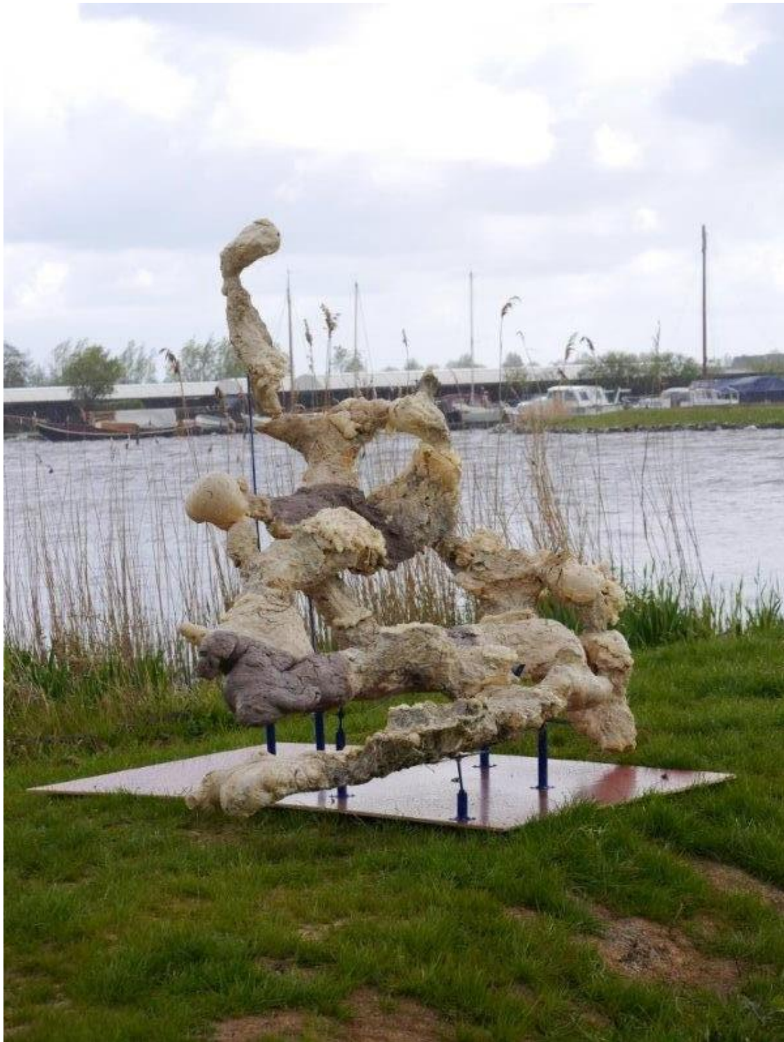
Een uit PUR-schuim opgebouwd model van een Muskusratten burcht. In totaal zijn in opdracht van de STOWA circa vijf van dergelijke modellen gemaakt om de omvang van de burchten, de nestkommen en de pijpen te kunnen meten (Akkermans 2014). De waargenomen diameter van de pijpen was ca. 15-25 cm, de nestkommen hadden een diameter van 0.5 m en de pijpen gingen anderhalf tot zes meter de kant in (Foto: D. Moerkens, UvW).
