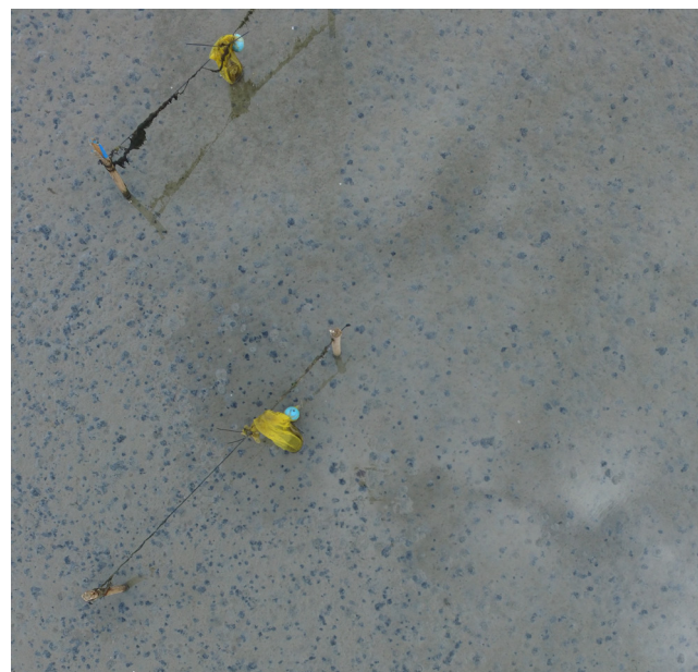
Dronefoto van twee proefvlakken bij Texel. Het bovenste is voorzien van gaas in de bodem. Het onderste heeft geen gaas. Algen en golven hebben in beide vrij spel. De foto laat zien dat wadpiëren in het bovenste proefvlak wegblijven. Foto: The Fieldwork Company.
